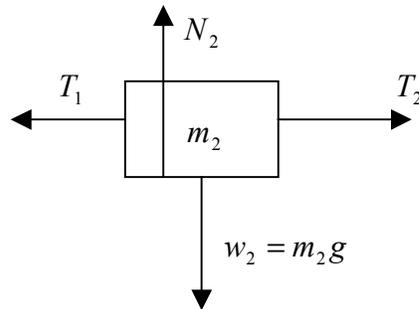
$\vec{T}_1$  es la tensión que aplica la cuerda de la izquierda sobre  $m_2$  y  $\vec{T}_2$  la tensión que aplica la cuerda de la derecha sobre la misma masa.
