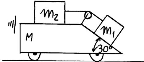
2. Entre las superficies en contacto que muestra la figura, el coeficiente de roce estático  $\mu_e$  es 0,6 y el coeficiente de roce cinético  $\mu_c$  es 0,4. Determine el valor máximo de la masa M, para que el bloque de masa  $m_1 = 1[\text{kg}]$  que descansa sobre el cuerpo de masa  $m_2 = 2[\text{kg}]$  no deslice.
